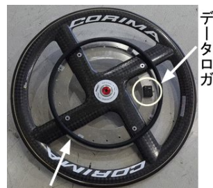
図2 ハンドリムとデータロガを取り付けた計測用ホイール
