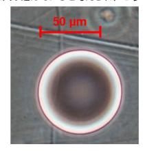
でも射出が可能であり、基板には疎性の大きな四フッ化エチレン・六フッ化プロピレン共重合体(FEP)を用いる事により、直径 0.075mm において、厚さ 2.26 μm のディスクを形成することができた。エッジのテーパー角は 19 度と大きくディスクセンサーとして良好な品質である。屈折率の低下で光学直径は 109μm と 20%を削減できた。レーザー発振によるしかしながら、WGMモードも確認できたが、FZ-001 は非特異吸着においてはアルブミン吸着率などが低く、水中の吸着利用については特性が劣ることも明らかになった。表面改質も試みたが、大きな改善は得られなかった。
