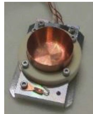
図2 垂直型低速陽電子ビームチャンバー内に設置した温度可変液体測定用試料容器。
