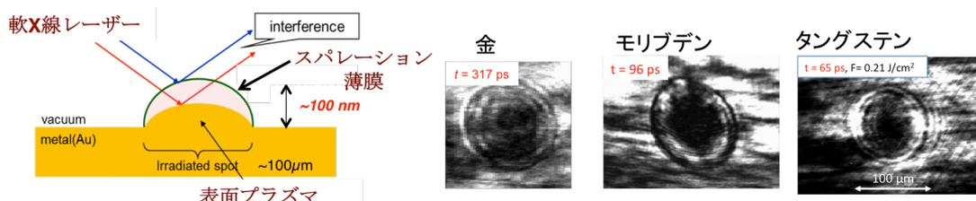
図1 固体表面からのスパレーションを利用したX線ビームスプリッターの概念図(左)と各金属サンプルに対して各々の表面で観測された軟X線領域のニュートンリング
