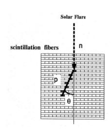
観測効率はモンテカルロ計算によると約2%である。 陽子はシンチレータで衝突後、太陽方向から約40度以内に放出される。太陽方向は太陽センサーの情報から分かるので、太陽からの中性子であることも検証もできる。図に示すように入射した中性子は、シンチレータ中の水素や炭素原子核と荷電交換反応により陽子に変換され、エネルギーが計測される。
