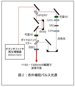
そこで、本研究でもこの結晶を入手して光源の作製を行った(図2)。現時点ではまだパルス圧縮の最適化の途中だが、すでに時間幅60フェムト秒の赤外パルスが得られている。これは上述の半導体材料でコヒーレントフォノンを励起するのに十分な値である。
