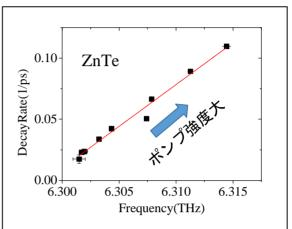
図1:ポンプパルス強度を変化させたときの コヒーレントフォノン振動数と減衰レート の変化(ZnTe 単結晶の場合)。
