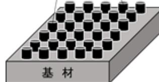
図2 ナノドットDLC膜の模式図
