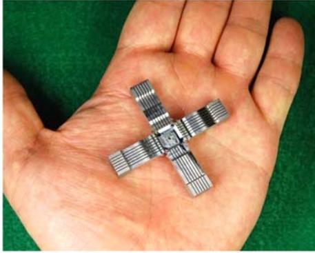
図2 機械加工した小型十字型試験片
