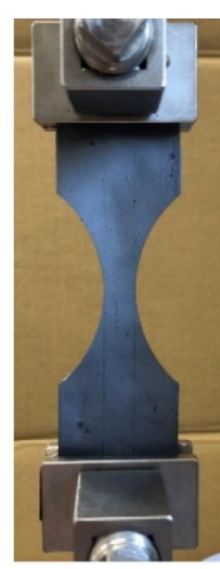
図2 引張試験機に取り付けられた試験片
