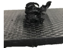
図 2 軸砥石加工によるバリ
