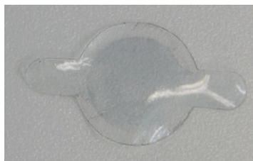
図 6 試作した単層の誘電エラストマーアクチュエータ
