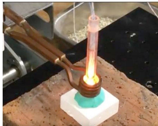
図 5 電磁誘導加熱による自己伝播発熱反応
