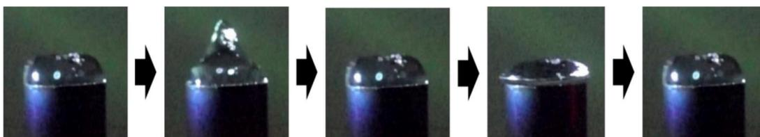
図 4 脈動電圧の印加により振動する水滴のコマ送り写真 ( $f=21.5$  Hz)
