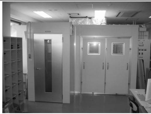
図4．温度変化に対する位置決めロバスト性能評価に用いる恒温恒湿ルーム H16～17年度基盤研究Aで整備した恒温恒湿ルーム内で温度設定を可変して実機検証することで，温度変化による特性変動を実際に模擬可能であり，提案補償器設計のロバスト性能評価を直接実施できる。
