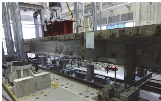
図-10 実橋梁から撤去されたPC桁
