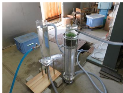
写真-2 植生されたポーラスコンクリートの透水試験
