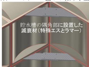
図 3-3 ルジング用制振装置
