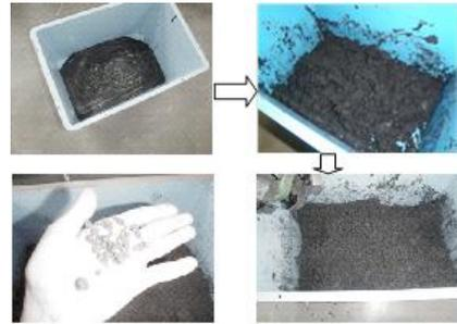
図2 浚渫土砂の造粒化の様子
