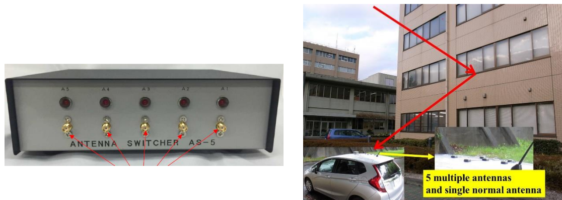
図2 複数アンテナ用の機器とその実験概要
