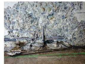
写真3 ダンパー鉄筋の破断およびコンクリートの剥落 (UPT-IC)
