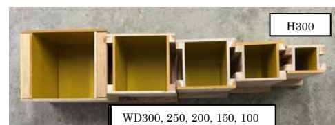
写真1 小型試験体作製用型枠
