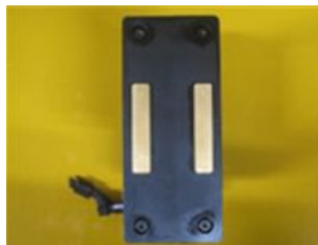
写真4 測定装置の電極側の状況
