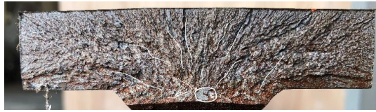
写真1 R35r10CF0の破断面
