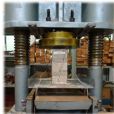
図 2 組積試験体と加力装置
