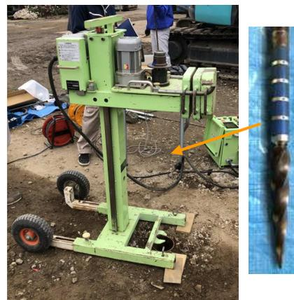
写真 1 電気比抵抗を利用した SWS 試験
