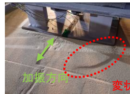
写真 1 加振後の地盤変状
