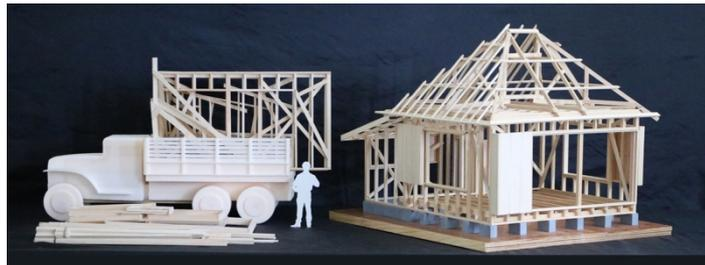
図2 規格住宅軸組模型
