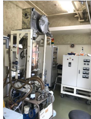
図1 大気中砥粒塗布と真空炉ろう付けを接続して連続製造装置に改良
