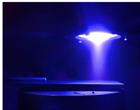
図 1 Ar 雰囲気中における B_4C HiPIMS プラズマ放電の様子
