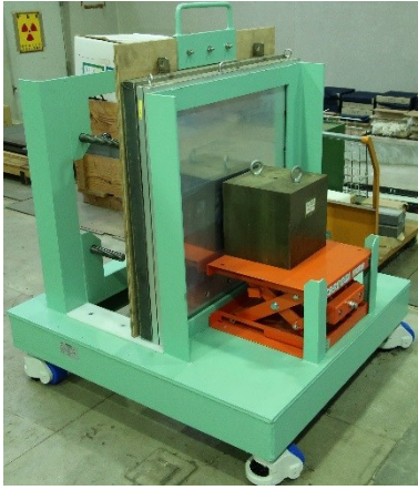
図 3 多重層遮蔽を模擬する治具、線源コリメータ、遮蔽板（水タンクと鉄）の実験配置
