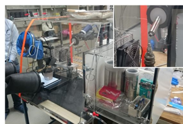
図 3. 嫌気ボックスに導入した吹付型冷却装置。右上は結晶近傍の拡大写真
