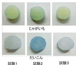
写真1 ブルーデキストラン(200万Da)浸漬による食材内部への拡散の様子
