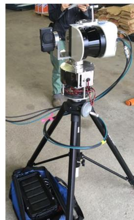
図 1.本研究で使用した地上レーザーセンサーである SICK LMS511 と回転台、三脚
