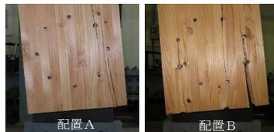
図12 破壊状況の比較
