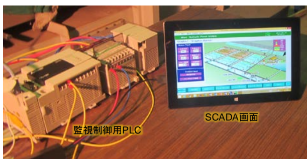
図5 構築した SCADA システム
