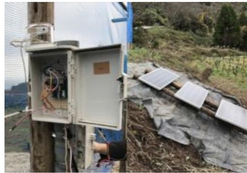
図3：果樹園に設置したセンサとソーラパネル
