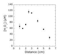
フリッケ線量計溶液の吸光度が  $H_2O_2$  で変化するかどうかを確認した。その結果、 $H_2O_2$  濃度に比例して吸光度が増大することがわかった。 のデータのうちの  $H_2O_2$  の寄与を見積もると、照射距離が 3 cm 以上における吸光度変化のかなりの割合が  $H_2O_2$  によるものとわかった。 呈色法により  $NO_2$ -を測定したところ、プラズマ照射によって照射時間に依存して  $NO_2$ -が
