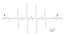
上と同様に DMPO 溶液を用い、・OH と反応して DMPO-OH シグナルの強度を殆ど見えなくするような濃度で DMSO を添加した溶液条件でプラズマを照射すると、スーパーオキシドラジカル(・ $O_2$ -)の DMPO アダクトの ESR スペクトルが観察され、・ $O_2$ -が生成していることが明らかになった。
