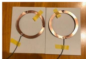
図4 並列共振回路を1つ、もしくは2つ組み込んだループコイル
