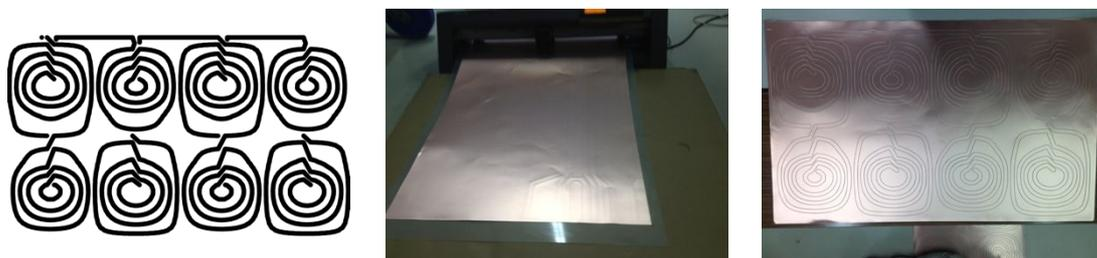
図1 申請者等が開発した超薄型アクティブシムコイル開発技術。設計したシムコイルパターン(左)をカッティングプロッタ(中)を用いて0.1mm厚のPCB基板の銅箔部分のみを切り取り(右)、傾斜磁場コイルに積層する。
