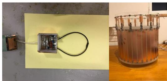
図5 開発した高インピーダンスコイル技術を用いた受信コイルと7T用送信コイル
