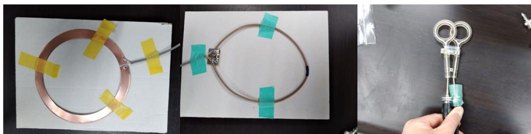
図6 開発したループ型シムコイル(左)、高インピーダンス型シムコイル(中)とダブルピックアッププローブ(右)
