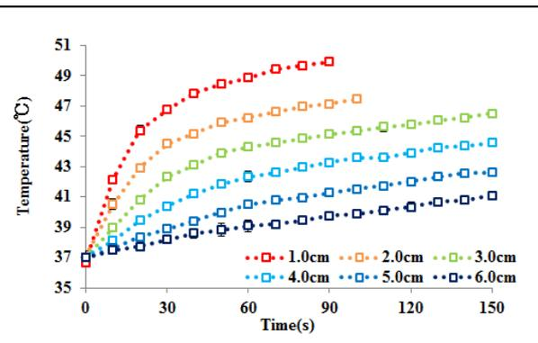
図 5：恒温槽下 Au-FILCT 発熱効果と深度
