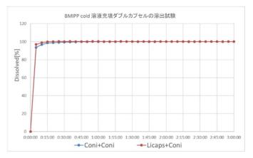
験機に投入した。溶出液薬局方 1 液 (pH1.2) 中で 50 rpm で撹拌し、サンプリング間隔 5 min で計測した溶出率である。封入後 5 分で速やかに溶出している。
