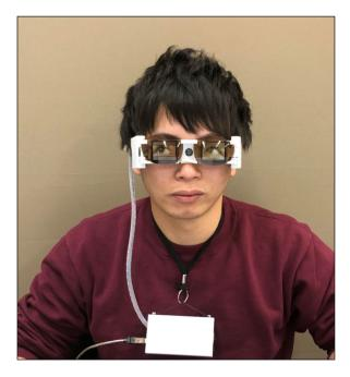
装着者に対面者の注視行動を伝達するために、対面者の頭部回転角度と視線方向を取得する必要がある。これらの情報から、対面者の注視方向を計算し、振動によって装着者に伝達する。次に、対面者に対して装着者の注視行動を表現するために、装着者の頭部回転角度を取得する必要がある。対面者の注視方向と装着者の頭部回転角度から、対面者と同じ方向に視線を向けているように表現することが出来る。装着者の視線の表現は、さまざまな方向に視線を向けている目の写真を複数枚用意し、液晶に表示させることによっておこなう。
