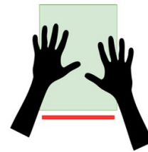
図 4 センサー位置：手による妨害を避けるため タブレットの 20 cm 後方に移動
