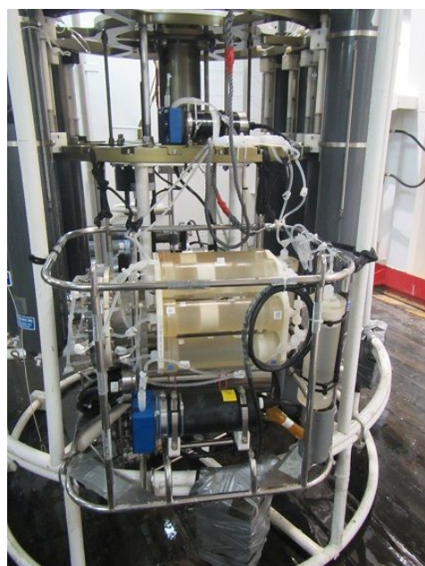
図2. ロゼッタ採水装置上に設置された ROCS 現場培養機。
