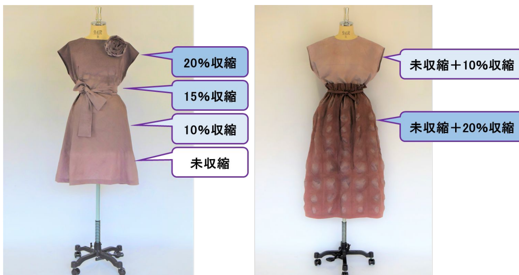
図4．ポリ乳酸繊維の収縮加工テキスタイル (染料, 染料による混色一浴法染色)
