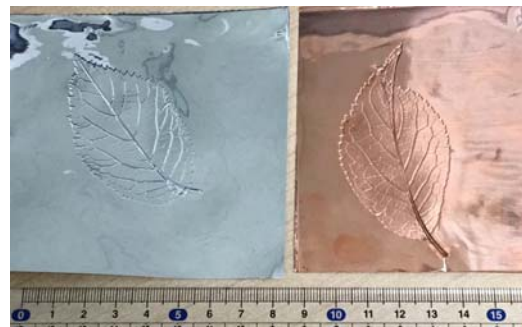
図 1 衝撃成形によるカンヒザクラ ( Cerasus campanulata (Maxim.) Masam. & S.Suzuki) 葉のレプリカ (左: アルミニウム板・凸面、右: 銅板・凹面)
