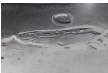
図3 衝撃成型後のアルミニウム板上の気泡痕
