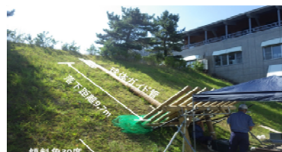
図7 落石の落下エネルギー計測状況
