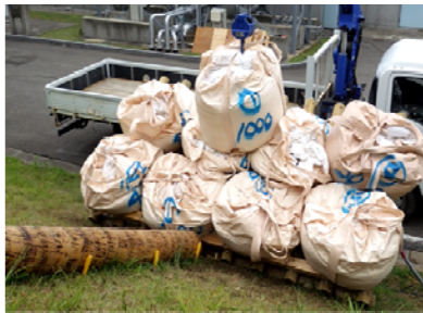
(a) 載荷試験における計測柵上面の土嚢
