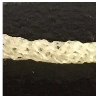
図3 16 組みロープ編みによる P2 の 3 次元構造体。
