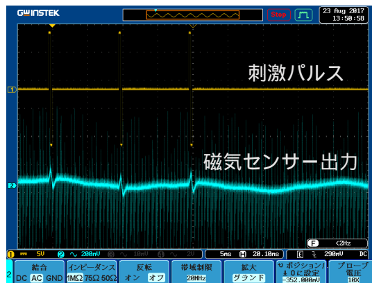
図5．刺激パルスに対する磁気センサー出力
