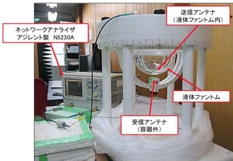
図 2 頭部ファントム測定治具と評価系
