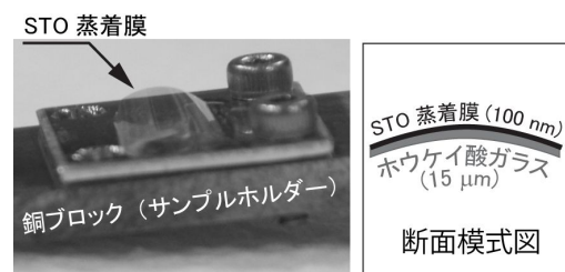
図2 : 試験測定 (図1) に用いた SrTiO 3 蒸着膜の写真と模式図
